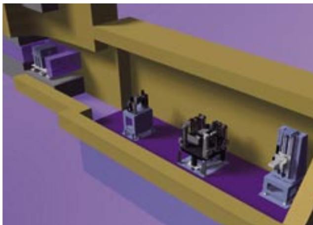
図2 試料水平型パルス中性子反射率計の概念図。
