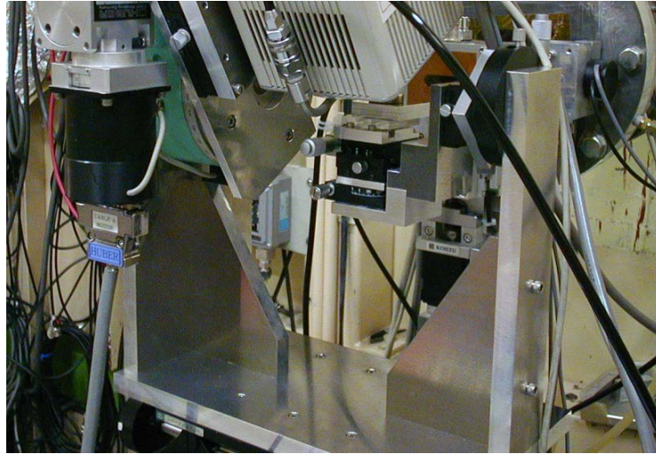
図ー6 完成したX線応力顕微鏡(タイプ2)、下流側に30度傾いた状態(回折角60度)。高エネルギー加速器研究機構放射光科学研究施設において実験中の様子を示している。
