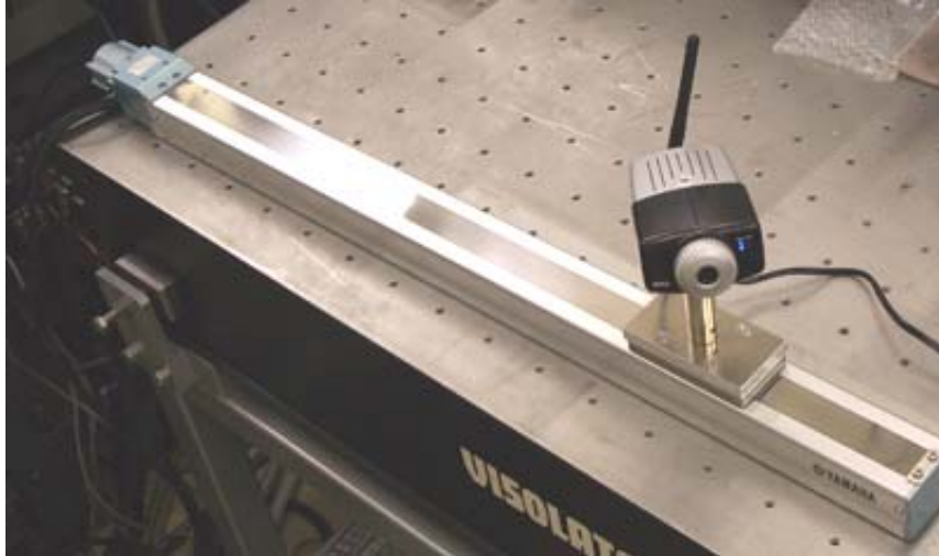
図 3.1-76 直進ロボットとカメラシステムを組み合わせたテスト。ロボット上のカメラが移動しながら連続撮像を行い、無線でデータを転送する。
