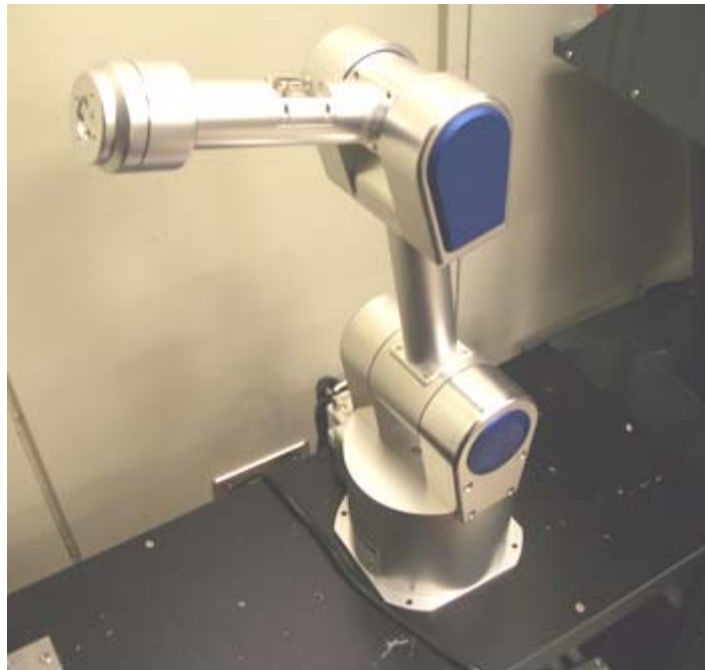
図 3.1-77 アーム式(垂直・多関節)ロボット。直進ロボットと組み合わせると、計測・分析へのさまざまな応用が有望になる。
